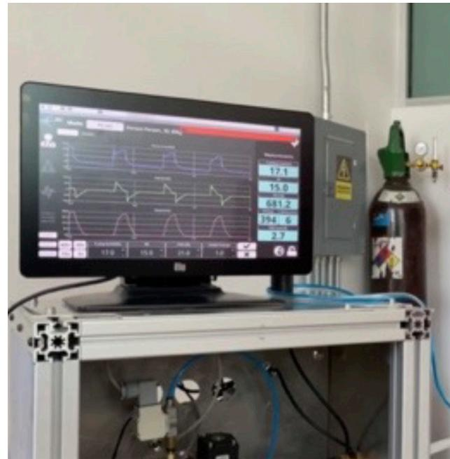
Ventilador HEV, conectado a un maniquí. El monitor del ventilador HEV muestra valores de presión, volumen y flujo de aire. Lugar: Laboratorio de Partículas, EcoCampus-BUAP.
