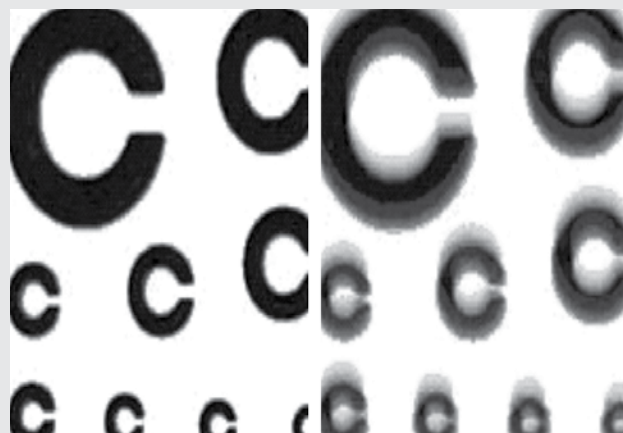
Fig. 3. Aberración cromática y su corrección mediante el uso de lentes de vidrios diferentes (izq). Ejemplo de imágenes sin y con este efecto (der).
