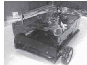
Figura 7 Sistema móvil localizador de fuentes de olor desarrollado en el LEyO, FCFM-BUAP.
