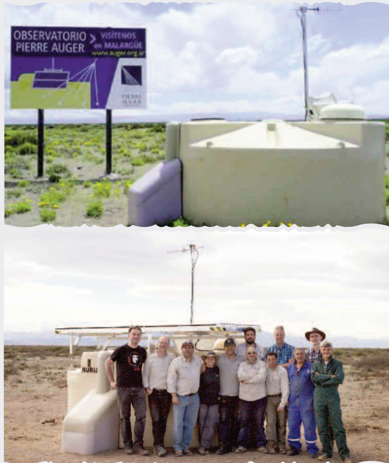
▲ Una de las estaciones del arreglo de superficie del Observatorio Pierre Auger. ▼ Primer SSD instalado en campo, en una de las estaciones del arreglo de superficie. En la imagen aparecen miembros de la Colaboración Pierre Auger, que se encargaron de su instalación.
