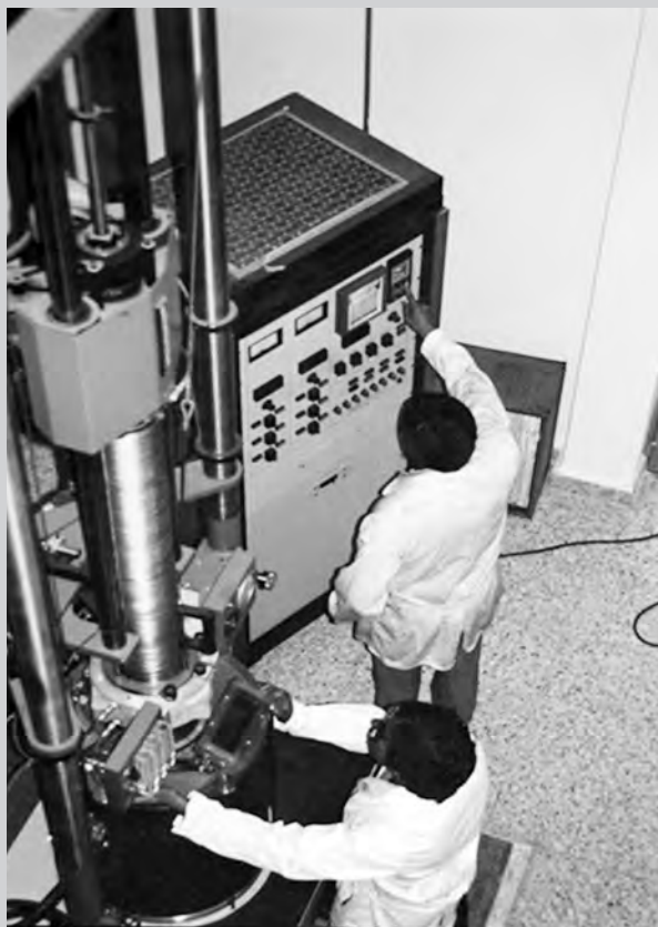
• Figura 3. Homo Czochralski para hacer crecer cristales de silicio, (Planta piloto de obleas de silicio, Departamento de Microelectrónica BUAP, 1985-2003, proyecto financiado por Conacyt)
