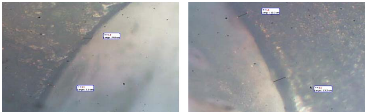
Figura 9) Medición en microscopio volumétrico con resina Te-Econom recipientes No.41 y No. 54
